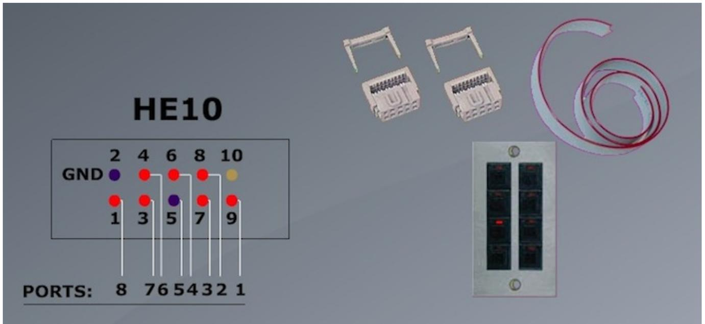
Vous pouvez connecter jusqu'à 255 boutons en utilisant des combinaisons binaires. Par exemple, si les ports 1,2 et 3 sont connectés à la masse, l'adresse 7 sera déclenchée.
